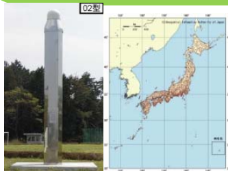
電子基準点と国内の設置箇所
